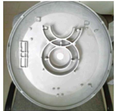
Bild 6: RP-Schwerkraft-Sandguss für Serienherstellung Druckguss, Material: AlSi10Mg, Wandstärke 3,0 mm, Abmessung: Ø 540 mm
