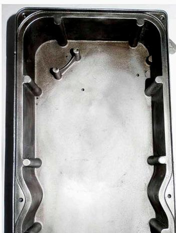
Bild 2: Dünnwandiges Sandformgussteil mit einer Länge von 430 mm mit einer durchschnittlichen Wandstärke von 2,5 mm
