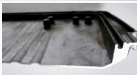
Bild 3: Dünnwandiges Sandformgussteil mit einer Länge von 540 mm mit einer durchschnittlichen Wandstärke von 3 mm
