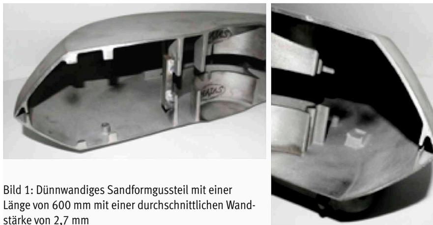
Bild 1: Dünnwandiges Sandformgussteil mit einer Länge von 600 mm mit einer durchschnittlichen Wandstärke von 2,7 mm
